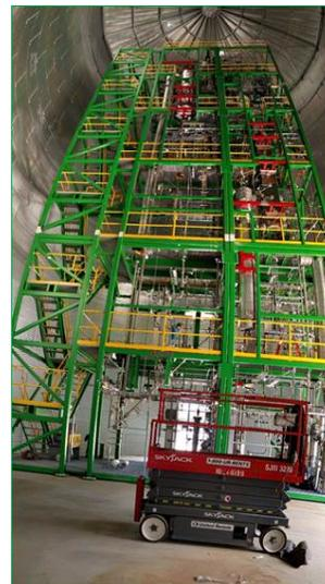
L'impianto pilota, realizzato in collaborazione con Suntory (che punta ad usare il bioPET per produrre imballaggi e bottiglie), utilizza la tecnologia di catalisi termica Bio-TCat, in grado di convertire biomasse non edibili (come legno, stocchi di mais e bagassa) in prodotti aromatici, quali il paraxilene necessario alla produzione di PET, ma anche benzene biobased per la sintesi di poliammidi, policarbonato, poliuretani e ABS.
