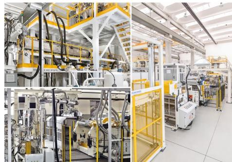
L'impianto per la lavorazione di foglia rigida multistrato è allo stato dell'arte per dotazioni tecnologiche e prestazioni: può raggiungere una produttività massima di 2.000 kg/h, con una gamma di spessori compresa tra 0,15 mm e 1,50 mm e larghezza utile fino a 1.860 mm. Oltre al PET, vergine e riciclato, può estrudere anche A-PET, C-PET, PET-G e acido polilattico (PLA).
