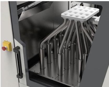
**SENZA COLONNE PER IL MEDICALE.** Si resta nello stampaggio tecnico, ma si passa al settore medicale, con la Engel e-victory 170/80 allestita per stampare in Fiera un porta aghi di siringhe di sicurezza da 1 ml (peso della stampata 0,08 grammi, tempo di ciclo di 6 secondi), dotata di un distributore in acciaio inox che provvede alla separazione dei pezzi stampati per cavità (nella foto), convogliati in un contenitore che riporta il numero di impronta che li ha prodotti, al fine di garantire la
