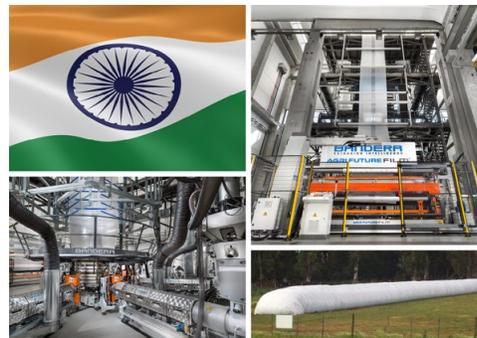
L'impianto è in grado di produrre film con larghezza fino a 14 metri (aperto), spessori da 100 a 250  $\mu\text{m}$ , con una produttività superiore a 1.200 kg/h. È anche possibile trasformare resine barriera EVOH/PA grazie all'innovativo design della testa di estrusione.
