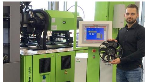
Per sviluppo applicativo, prove stampi e formazione, è stata installata una cella di lavoro basata su una pressa duo 350 (forza di chiusura di 300 tonnellate), robot easix e unità per schiumatura T-200 MuCell fornita dal partner tecnologico Trexel. Nel laboratorio, a disposizione dei clienti, è presente un tecnico esperto di questa tecnologia, Lukas Neunzig (nella foto), che ha già seguito numerosi progetti di implementazione di impianti MuCell a livello mondiale.
