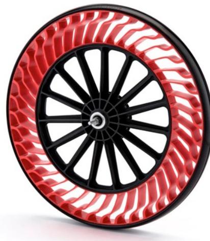
Il sistema si basa infatti su un mozzo collegato da raggi in materiale plastico ad un primo cerchione sempre in plastica. Da qui si diramano delle lamelle flessibili in resina termoplastica collegate ad un cerchione dotato di un sottile battistrada in gomma piena, privo di camera d'aria.
