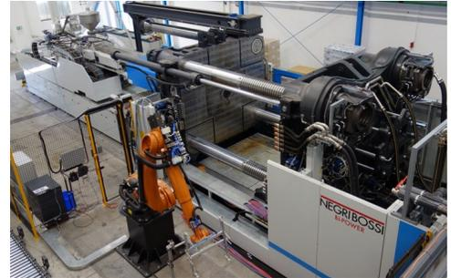
**EQUIPAGGIAMENTO.** La macchina ha una capacità di iniezione pari a 28 kg di HDPE, disegno vite barriera ottimizzato per lavorare materiale riciclato e azionamento servoelettrico per la rotazione del gruppo di plastificazione al fine di contenere i costi energetici e allungare la durata della vite. In alternativa, può montare una vite a tre zone per lavorare materiali carichi minerali o fibra di vetro, sfruttando il sistema di cambio rapido attraverso la rotazione del gruppo di plastificazione.
