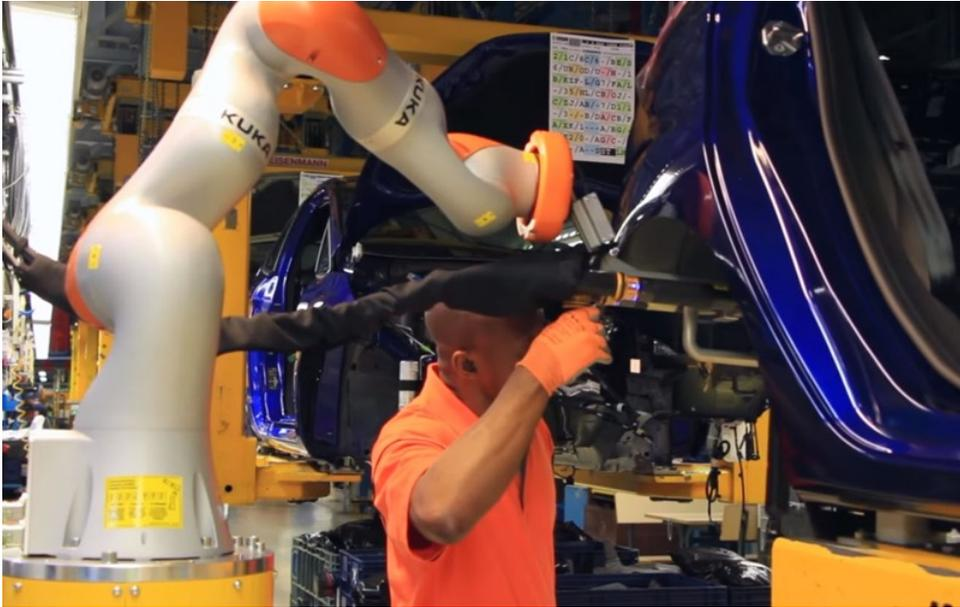
I robot collaborativi, o cobot, lavorano fianco a fianco con gli operai senza barriere di sicurezza, grazie a sensori e dispositivi che rendono la macchina capace di riconoscere la presenza umana ed evitare incidenti.
