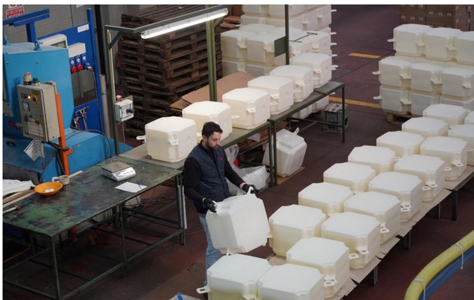
**220.000 BLOCCHI DI HDPE.** The Floating Piers galleggia sull'acqua, seguendo il movimento delle onde, grazie a 220mila parallelepipedi cavi (50x50x40 cm) in polietilene alta densità collegati tra loro in 32 spezzoni di 100 metri di lunghezza attraverso viti di plastica fissate in
