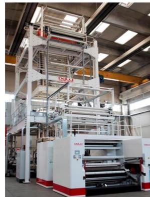
Le macchine, afferma il gruppo novarese, si caratterizzano per un risparmio energetico intorno al 20-25%, raggiunto installando nuovi riduttori, motori raffreddati ad acqua e viti a basso "shear".
