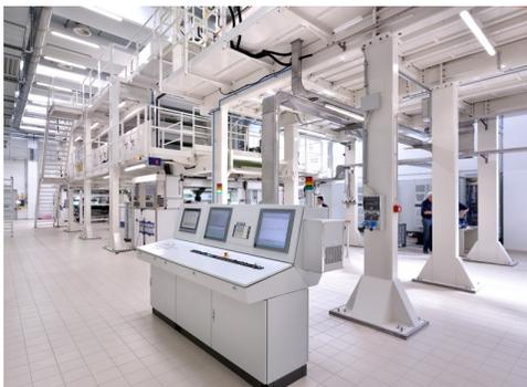
**CAMERA BIANCA.** Prima di entrare, uomini e materiali passano in una bussola dove una doccia ad aria elimina tutti i contaminanti dai vestiti e dalle bobine, poiché tutta l'area produttiva è racchiusa in un ambiente controllato in sovrappressione, con ricircolo d'aria e filtraggio a 5 micron, per assicurare al processo produttivo gli standard di una camera bianca.
