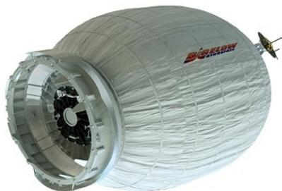
**GONFIATO NELLO SPAZIO.** Messo a punto dalla americana Bigelow Aerospace, Beam - acronimo di Bigelow expandable activity module - una volta gonfiato avrà un volume di 16 metri cubi, una lunghezza di 4 metri per una larghezza di 3,2 metri. Il modulo è composto da due paratie di metallo, una struttura in alluminio, un rivestimento multistrato costituito da layer alternati di un tessuto sintetico brevettato e da un isolamento in espanso
