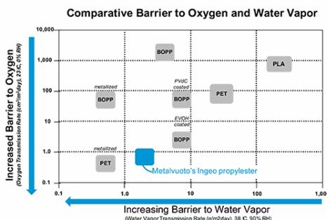
PROPRIETÀ BARRIERA. Propylester Ingeo ha proprietà barriera inferiore a 0,75 cc/m<sup>2</sup>/24 ore per l'ossigeno - quindi migliore rispetto al film BOPP metallizzato - e 2,5g/m<sup>2</sup>/24 ore per il vapore acqueo.
