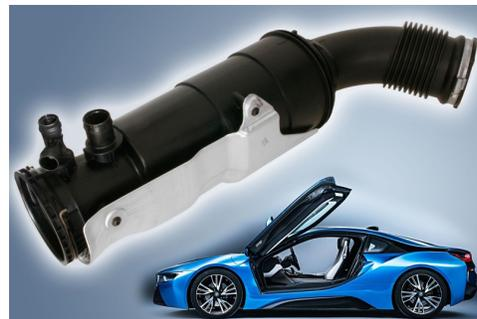
COME FUNZIONA. Il componente, montato tra il filtro aria e il turbocompressore, ha la funzione di ridurre la rumorosità del motore, migliorando il comfort dei passeggeri. Nonostante le dimensioni, necessarie per trasformare le alte frequenze in basse frequenze, il pezzo pesa solo 1,5 kg, grazie all'impiego di materiali plastici e all'ottimizzazione dello spessore parete, consentito dalle proprietà meccaniche del grado Zytel Plus selezionato.
