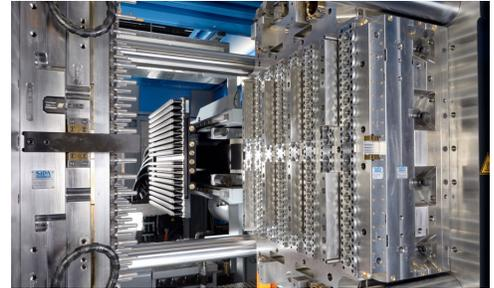
Le macchine si affiancano ad una decina di presse Husky già in funzione nei reparti dell'azienda iraniana: sono destinate alla produzione di preforme PET destinate al soffiaggio di bottiglie per bevande gasate, latte (collo da 38 mm) e acque minerali.
