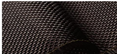
I risultati della sperimentazione serviranno a mettere a punto il processo di riciclo delle fibre, basato sulla decomposizione termica, ad alta efficienza, del materiale composito. In sostanza, le fibre sono estratte riscaldando il materiale e provocando la decomposizione della matrice polimerica.
