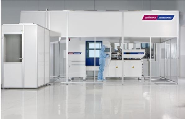
Tra le più interessanti isole di stampaggio esposte quest'anno a Fakuma si segnala quella allestita da Wittmann Battenfeld per la produzione di un porta lenti a contatto in polipropilene in condizioni di camera bianca. Protagonista una pressa all-elettrico EcoPower 110/350 dotata di separatore di pezzi fuori standard e nastro trasportatore incapsulato, installato sotto il gruppo di chiusura.
