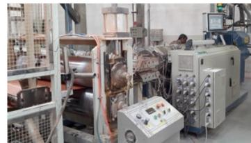
L'impianto può estrudere direttamente una lastra in PVC caricato, con rivestimento esterno protettivo a base di tecnopolimeri adatti a resistere ai raggi UV, con sagomatura in linea che riproduce la forma delle tegole.
