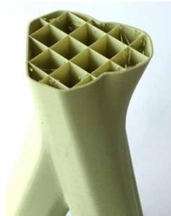
Per superare i limiti intrinseci del biopolimero, le sezioni dei tubi telaio sono rinforzate mediante strutture a nido d'ape nei punti di maggiore sollecitazione.
