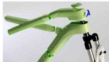
Frutto di un'accurata progettazione strutturale della forma e dimensione degli elementi, per garantire la necessaria rigidità e resistenza meccanica, i diversi pezzi del telaio sono stati prodotti mediante modellazione a deposizione fusa (FDM) utilizzando 5 kg di bioplastica, con un costo del materiale intorno agli 80 euro.
