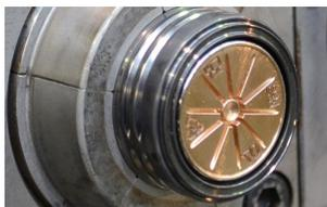
Il costruttore alessandrino di stampi Gefit ha messo a punto uno stampo a 72 cavità, con tecnologia a carrelli per la realizzazione del sigillo di garanzia, con il quale si ottengono tappi 1881 con peso di soli 1,8 grammi, destinati alla chiusura di bottiglie PET per acqua minerale e bevande a media gasatura.
