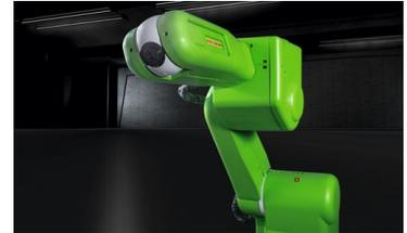
Il robot a sei assi, con estensione del braccio fino a 1.813 mm, è adatto per una vasta gamma di impieghi a livello industriale, ovunque vi siano lavori ripetitivi che prevedono la movimentazione di carichi pesanti, tipici dei settori automotive, packaging e lavorazione dei metalli.
