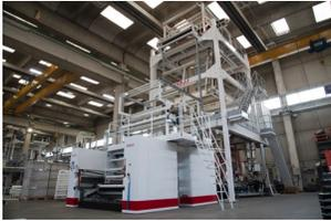
Approfittando della vetrina offerta da Plast 2015, Amut Dolci Bielloni ha messo in funzione presso la sede di Biassono (MB) un impianto per la coestrusione in bolla di film termoretraibili, estensibili (stretch hood), per la laminazione dell'imbballaggio, con larghezza di 2.500 mm e produttività oraria fino a 750 kg.
