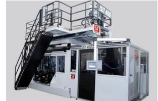
La struttura, progettata per essere esente da vibrazioni, si articola su due basamenti: quello superiore ospita l'estrusore e la testa di accumulo; il blocco inferiore accoglie invece il gruppo di chiusura e l'unità di soffiaggio. La struttura superiore è mobile e regolabile elettricamente nelle tre direzioni con controllo della posizione tramite trasduttori magnetostrittivi.
