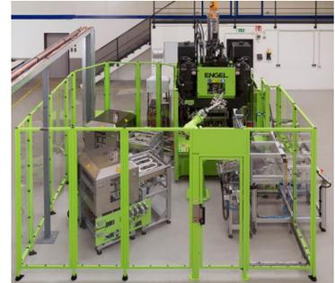
L'impianto, composto da due forni, una pressa ad iniezione e relativa automazione, produce pezzi finiti mediante sovrastampaggio di resina termoplastica su Tepex, una foglia organica ottenuta rinforzando una resina termoplastica con fibre di vetro continue.
