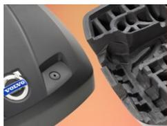
Il componente presenta una doppia natura materica: espanso a celle aperte nella parte inferiore, con caratteristiche fonoassorbenti; pelle consistente, di buona apparenza superficiale e decorabile a stampa, sulla superficie rivolta all'esterno.
