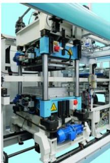
Il modello FC 780 IM2 che sarà esposto a Milano presenta un'area di formatura di 780 x 570 mm e consente di formare e tagliare il prodotto nella stessa stazione, oppure di eseguire il taglio in una seconda stazione in linea, provvedendo poi all'impilaggio ed alla evacuazione su nastro delle pile di prodotto contato.
