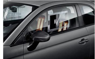
Le lastre in materiale plastico, utilizzate al posto del vetro per risparmiare peso, sono prodotte con policarbonato Lexan di Sabic e sottoposte a rivestimento protettivo Exatec, che garantisce elevata resistenza a graffi ed abrasione senza pregiudicare la trasparenza. I "cristalli" vengono forniti e assemblati da Isoclima, azienda che da due decenni lavora con alcuni grandi team nel mondo delle corse.
