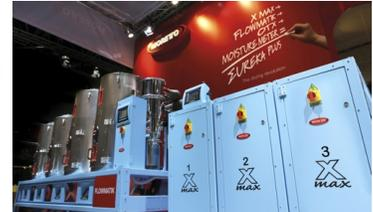
Eureka si compone di tre elementi: il sistema di gestione e distribuzione dell'aria FlowMatik, la tramoggia di deumidificazione OTX e il dryer X MAX.
