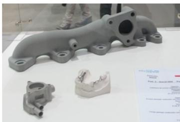
Realizzati dalla Ridix, questi tre modelli mostrano le potenzialità della prototipazione rapida con diversi tipi di materiali. Il collettore di scarico è stato prodotto con PMMA, la protesi dentale invece in CrCo, ottenuta con fusione laser selettiva, mentre il corpo pompa a sinistra in alluminio, anche in questo caso mediante fusione laser selettiva.
