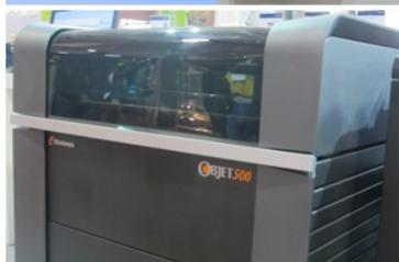
Stratasys espose in Fiera Object 500, stampante 3D in grado di produrre pezzi multimateriale e colorati per ottenere modelli, stampi e prototipi sempre più realistici e vicini, per caratteristiche e aspetto, ai prodotti finali.
