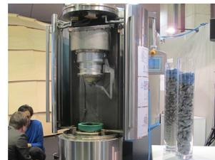
Il materiale da scomporre nei suoi costituenti viene posto in un contenitore, inserito nella macchina, dove  sottoposto ad una scarica elettrica pulsata, ad alto voltaggio, che dura meno di 500 nanosecondi. La scarica, che ha la potenza di un'esplosione di tritolo, si propaga tra le fasi del composito, rompendo i legami che le uniscono.
