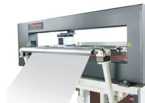
Il sensore, che utilizza sorgenti radioattive incapsulate Kr-85 or Sr-90, è in grado di operare su film con peso tra 6 e 7.000 grammi per metro quadrato. Il modello con sorgente Kr-85 è rivolto in modo specifico alla misura di film a spessore molto sottile, offrendo una vita utile cinque volte superiore a quella dei sensori convenzionali.
