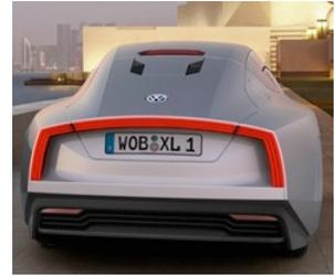
Il lunotto è in policarbonato trasparente (Lexan) sovrastampato con resine opache XCM Cicoloy (PC/ABS), per integrare, non a vista, funzioni come il fissaggio dell'illuminazione o l'antenna.
