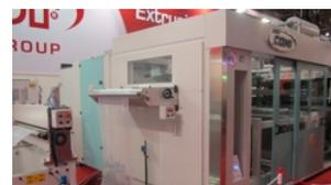
La fornitura, che sarà completata tra la fine di quest'anno e i primi mesi del 2014, comprende una termoformatrice AMP630 per la produzione di bicchieri in polipropilene da 240 ml (3,2 grammi). L'impianto - nota l'azienda - è dotato di un nuovo software sviluppato in collaborazione con Bosch Rexroth per la gestione dei tempi di formatura e impilaggio. Nuovo è anche lo stampo a 35 cavità, che consente di produrre 75.000-80.000 pezzi ora.
