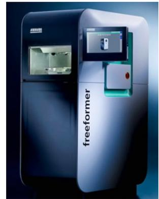
Freeformer è una stampante 3D per uso industriale che rivoluziona il modo di produrre manufatti in plastica "senza stampo", utilizzando le convenzionali materie plastiche in granuli e non polveri o filamenti.
