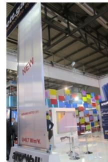
Grazie a speciali profili in alluminio, è possibile realizzare pareti traslucide e colorate senza limiti di larghezza (unendo insieme moduli larghi 500 mm), prive di strutture di sostegno secondarie per aperture fino a 3,5 metri di altezza.
