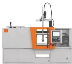
L'isola di stampaggio si basa su una pressa orizzontale made in Austria Maplan MHF700/300XL editionS (foto a sinistra) dotata di unità dâ€™iniezione FIFO-Duale e stampo a 4x54 cavità dello stampista ORP Stampi con tecnologia a Canale Freddo (CRB, Cold Runner Block) a 4 ugelli (foto a destra), con il quale si possono produrre, in un unico ciclo, fino a 216 guarnizioni da 0,25 grammi ciascuna.
