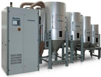
Modula risponde ai criteri di risparmio energetico fissati da BMW grazie alla possibilità di regolare automaticamente tutti i parametri operativi di ciascuna tramoggia, utilizzando il quantitativo di energia strettamente necessario. Questo compito è affidato a un software che interfaccia le impostazioni di ciascuna tramoggia con i dati acquisiti dai sensori.
