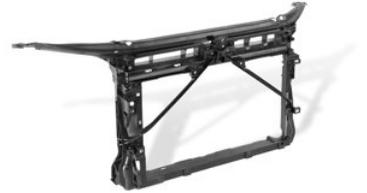
Rispetto ad altri componenti dello stesso tipo realizzati in passato, quello sviluppato da Faurecia per Skoda non prevede l'applicazione di placchette o altri rinforzi in metallo nei punti di maggior carico. Il pezzo pesa cos  il 25% in meno di uno equivalente in poliammide 6 standard con 30% fibra vetro, oltre a beneficiare di un processo di stampaggio ad iniezione pi  semplice e veloce, non essendo pi  necessaria la fase di posizionamento inserti.
