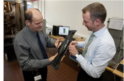
I due componenti, differenti per forma, dimensioni e funzione, sono realizzati in Tepex, foglie composite in fibra continua di carbonio, vetro o aramidica impregnate con resina termoplastica: soprattutto poliammide, ma è possibile utilizzare come matrice anche poliesteri, poliuretani o PPS. La foglia può essere sovrastampata con resine termoplastiche, migliorando ulteriormente le proprietà del pezzo finito (ad esempio l'assorbimento di urti), senza problemi di compatibilità o adesione.
