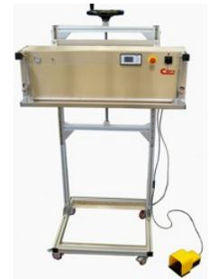
Il display visualizza anche gli allarmi e il programma di saldatura impostato (fino a 5). Il pannello è completato da un tasto per l'avvio del ciclo di saldatura e uno per l'operazione di autocalibrazione.
