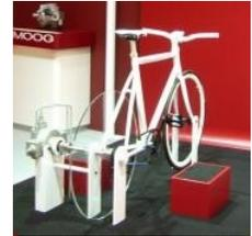
Per mostrare dal vivo l'effetto che si ottiene sulla richiesta di coppia e velocità al lato motore utilizzando una pompa RKP Moog oleodinamica a pistoni radiali, Moog ha messo a disposizione del pubblico la Speed Controlled Pump Bike Demo: pedalando, è possibile toccare "con piede" la funzionalità dual flow displacement, che consente di variare la cilindrata della pompa ed ottimizzare la potenza del motore nelle varie condizioni di carico, simulate attraverso la pedalata.
