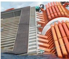
Il progetto "Compuerta flotante submarina" prevede la costruzione di una porta sottomarina quadrata (prima realizzazione subacquea al mondo) della stessa dimensione della bocca della diga, resa autonoma grazie alla perfetta adesione al cemento, alla tenuta idraulica e all'autopropulsione; la possibilità di manovra permette così l'accesso ai manutentori in totale
