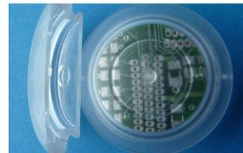
Si tratta di una tecnica per saldare insieme due pezzi in materiale plastico, creando un guscio che protegge dall'acqua e dall'aria circuiti elettronici o etichette RFID posti all'interno. Utile quindi per l'identificazione in radiofrequenza, utilizzata sempre più spesso in ambiti automotive, packaging, medicale ed elettronica.
