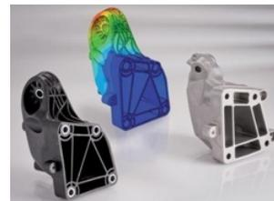
Realizzato mediante stampaggio di resina poliammidica altamente rinforzata Ultramid A3WG10 CR di BASF, il pezzo sostituisce un elemento in precedenza prodotto in alluminio, offrendo migliori proprietà acustiche, minore conducibilità termica e un peso inferiore, pur sopportando lo stesso carico.
