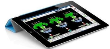
Con l'applicazione del nuovo dispositivo Ryng al sistema di alimentazione, Winfactory " ora in grado di calcolare il consumo energetico orario in watt per chilo di granulo plastico lavorato (Wh/kg), dato piú significativo, sotto il profilo operativo, rispetto al mero consumo energetico per ora di produzione (kWh).
