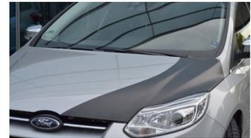
In occasione della fiera Composites Europe, è stato presentato il prototipo di un cofano per la Ford Focus realizzato interamente in fibra di carbonio, con un peso  $\pi^1$  che dimezzato rispetto allo stesso pezzo in acciaio; aspetto altrettanto importante, può  $\pi^2$  essere realizzato con un nuovo processo produttivo caratterizzato da tempi di ciclo ridotti, compatibili con una linea di produzione di serie, adattabile anche ad altri componenti auto.
