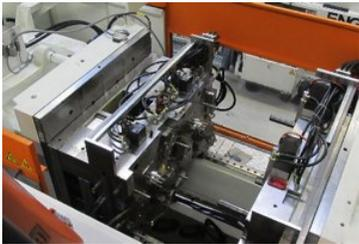
L'isola premiata è costituita da due presse a iniezione senza colonne (Engel victory 750/400 tech e victory 1050/400 tech) e due robot multiasse Kuka modello KR 60. Per la fabbricazione degli inserti destinati agli sportelli serbatoio, i supporti vengono prima sovrastampati con polipropilene rinforzato 30% fibre di vetro; sulla seconda pressa, i pezzi vengono poi corredati di una guarnizione in
