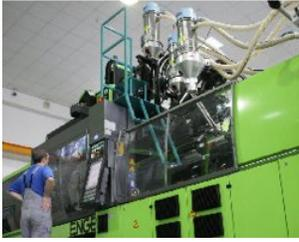
L'assenza di colonne ha consentito di installare quattro unità di iniezione su una pressa con forza di chiusura di sole 400 tonnellate e di combinare, in questo modo, lo stampaggio multicomponente con l'inserimento di inserti.
