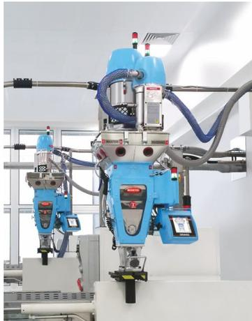
Per quanto concerne il dosaggio di miscele di materiale vergine, rigranulati e additivi, Moretto propone dosatori gravimetrici a batch o anche loss-in-weight con produzioni fino a 12 tonnellate ora, idonei al trattamento di ogni tipo di materiale.
