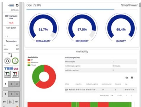
TemiOne offre le funzioni di Temi+ in termini di memorizzazione e analisi dei dati di processo, grazie ad un piccolo server installato nell'armadio della pressa. Dati che possono essere esportati utilizzando una chiavetta USB, quindi senza necessità di collegamento ad una rete aziendale.
