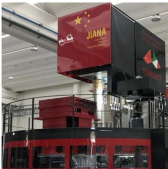
COME FUNZIONA. Il plasmix - spiega l'azienda friulana - viene pretrattato fino ad ottenere un conglomerato omogeneo, alimentato ad un gruppo di stampaggio ad iniezione a bassissima pressione, con più punti di iniezione dotati di otturatori di ampio passaggio, che hanno il compito di iniettare il conglomerato plastico all'interno di quattro diversi stampi, ognuno dei quali può originare un pezzo diverso per forma, peso e dimensione.
