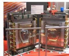
Cage System e 3iTech di RocTool utilizzano l'induzione magnetica per riscaldare velocemente lo stampo, sia nello stampaggio ad iniezione di termoplastiche che in quello a compressione, o RTM, di materiali compositi; il sistema opera in un'ampia finestra di temperature di processo, consentendo la produzione di pezzi con elevata qualità superficiale, che non richiedono operazioni di finitura.
